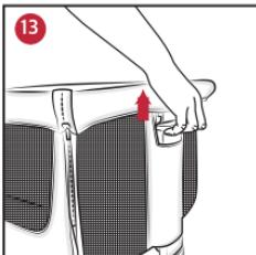
그림 13과 같이 요람 좌우 접합부에 위치한 레버를 위로 당겨 요람의 높이를 조정하여 주십시오. 6단계로 조절 가능합니다.
